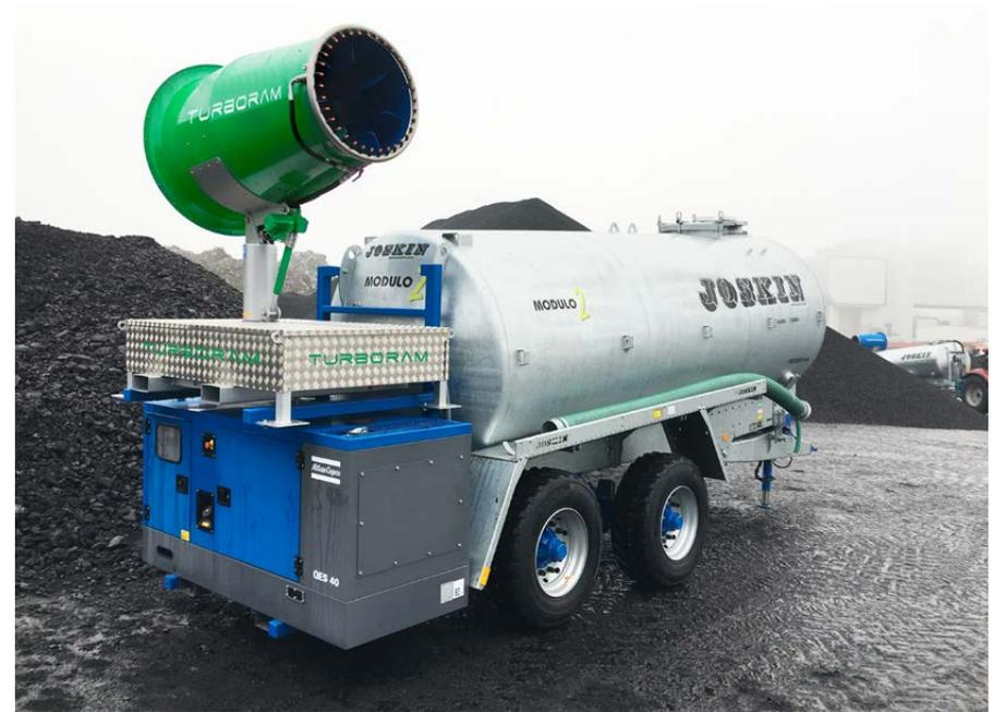
El cañón **TRD100-SC** es el más potente cañón de la serie Turbo RAM. Ha sido diseñado para trabajar en las aplicaciones más exigentes. Con generador y tanque de agua integrados, es capaz de cubrir una superficie de hasta 28.000 m², permitiendo al usuario una autonomía total.
