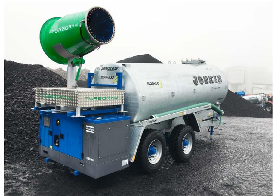
El cañón Turbo RAM TRD90-SC se ha diseñado para trabajar en las aplicaciones más exigentes. Con generador y tanque de agua integrados, y un alcance de hasta 90 metros, es capaz de cubrir una superficie de hasta 22.600 m², permitiendo al usuario una autonomía total.
