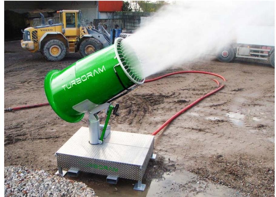
El cañón más potente de la serie Turbo RAM tiene un alcance de hasta 100 metros. El cañón **TRD100** está diseñado para el control de polución en grandes áreas, ya que es capaz de cubrir hasta 28.000 m² de superficie.
