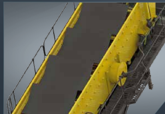
Ángulo ajustable de la caja de criba y altura ajustable de la cinta de alimentación
