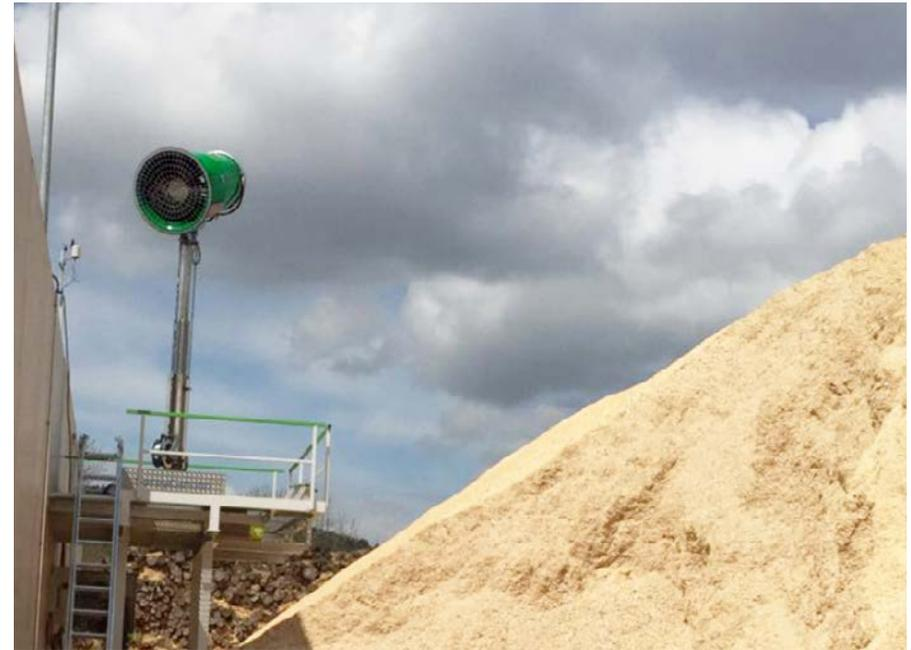
El cañón **TRD60-MT** con mástil retráctil, permite realizar un control preciso y eficiente de la polución, ayudando al usuario a adaptarse a distintas condiciones.
