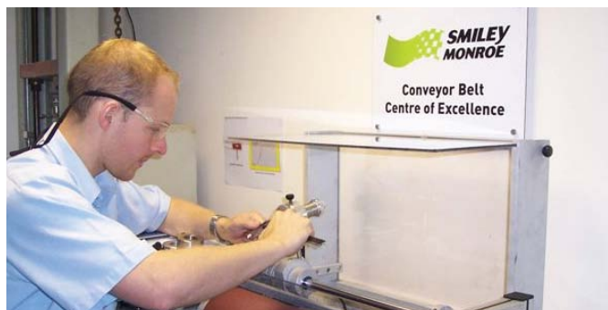
Prueba de resistencia al desgaste (abrasión) realizada de manera interna en Smiley Monroe
